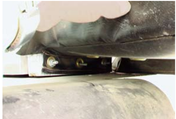
门罩安装短少螺丝，需补齐
